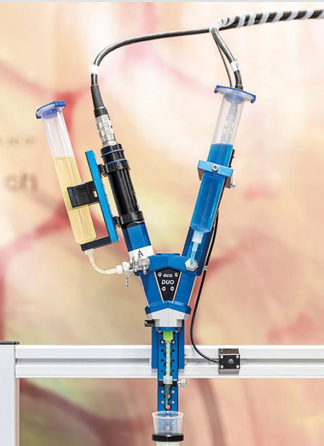
Les systèmes de mélange et de dosage bicomposants de preeflow® : un rendement volumétrique réel pour les matériaux à 2 composants. Des quantités infimes de fluides et de pâtes à 2 composants sont mélangées et dosées avec précision. Le rapport de mélange est réglé à la deuxième décimale par une régulation ciblée des différents composants. Un dosage propre et fiable est obtenu quelles que soient les fluctuations de viscosité.
