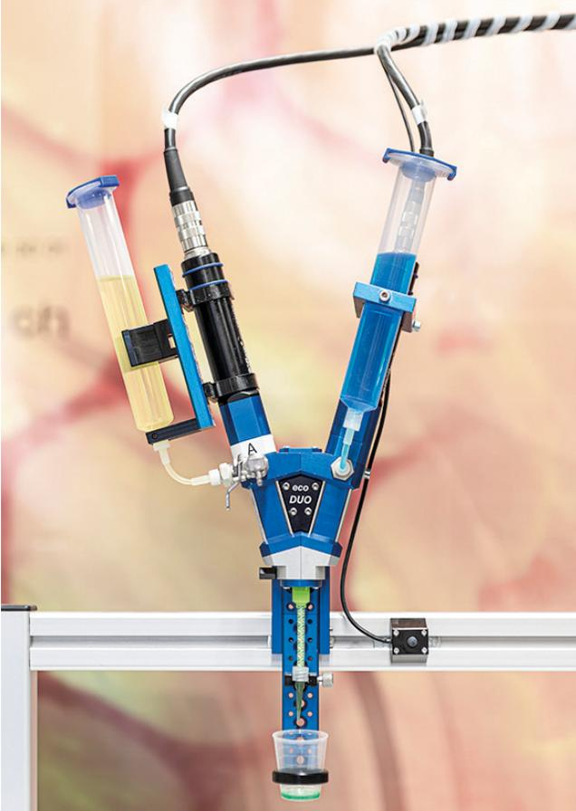
Die 2K Misch- und Dosiersysteme von preeflow®: rein volumetrisch für zweikomponentige Materialien. Kleinste Mengen zweikomponentiger Fluide und Pasten werden exakt gemischt und dosiert. Durch gezieltes Steuern einzelner Komponenten wird das Mischungsverhältnis bis auf die zweite Nachkommastelle eingestellt. Unabhängig von Viskositätsschwankungen wird eine saubere und prozesssichere Dosierung realisiert.
